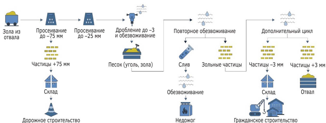
Рис. 15.6. Технологическая схема процесса опытно-промышленной установки обогащения золошлаковых отходов ТЭЦ-22 (Москва) с выделением недожога
