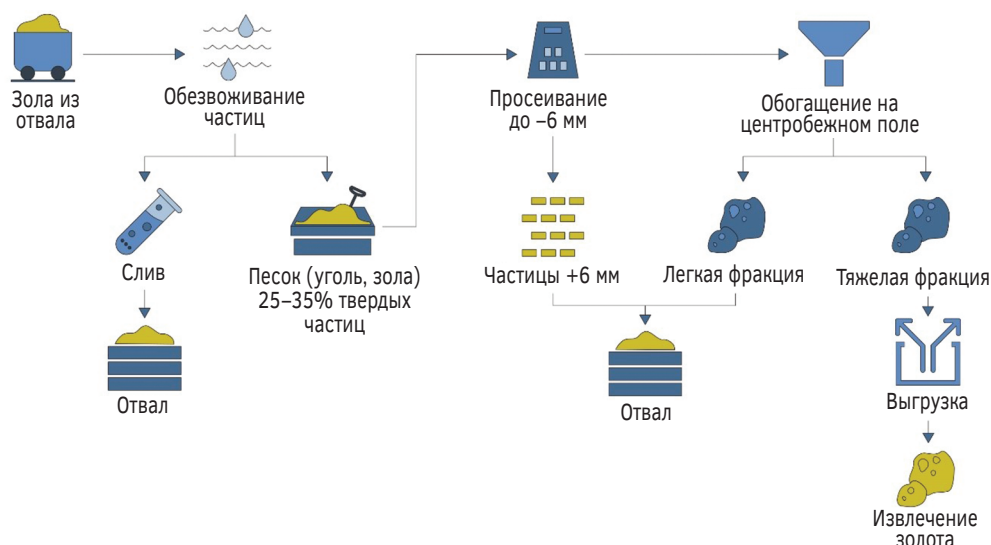
Рис. 15.8. Технологическая схема извлечения золота из ЗШО
