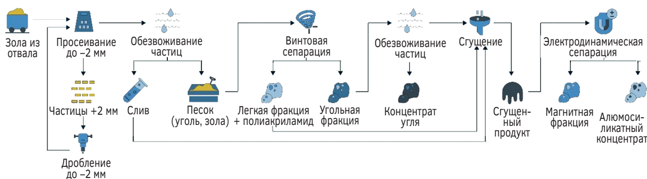
Рис. 15.9. Технологическая схема обогащения ЗШО с выделением магнитной фракции, алюмосиликатного концентрата и недожога
